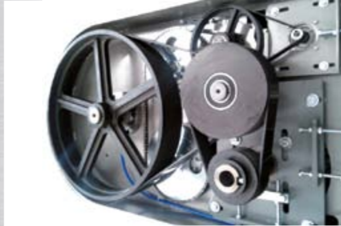
Doppia trasmissione spirale su Linea LUX-R Double spiral transmission on LUX-R Line
